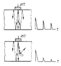
Рисунок 24. Многократные отражения ультразвуковых колебаний в тонком изделии
