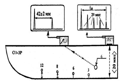
Рисунок 45. Проверка точности работы глубиномера дефектоскопа
