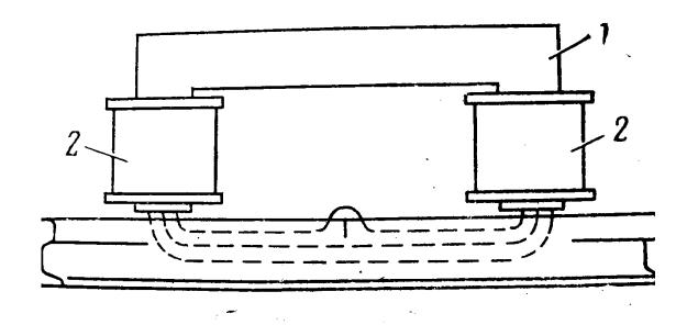
1 - ярмо; 2- намагничивающая катушка Рисунок 5. Схема намагничивания рельса
