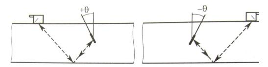
Рисунок 27. Обнаружение различно орентированных дефектов в головке рельсов
