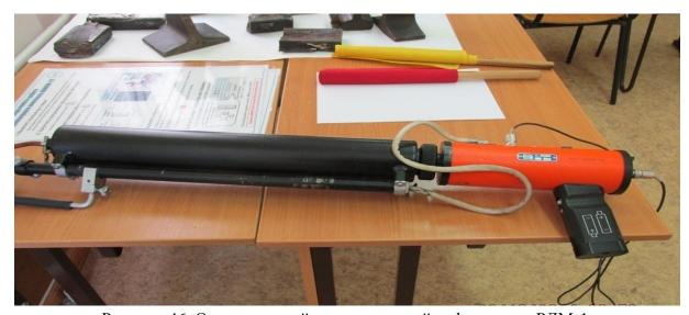
Рисунок 46. Однониточный ультразвуковой дефектоскоп РДМ-1
