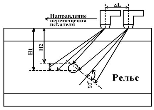
Рисунок 29. Схема определения протяженнисти дефекта
