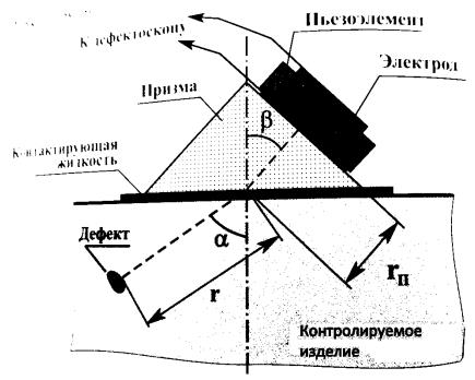
Рисунок 17. Ввод ультразвуковых колебаний с помощью наклонного преобразователя
