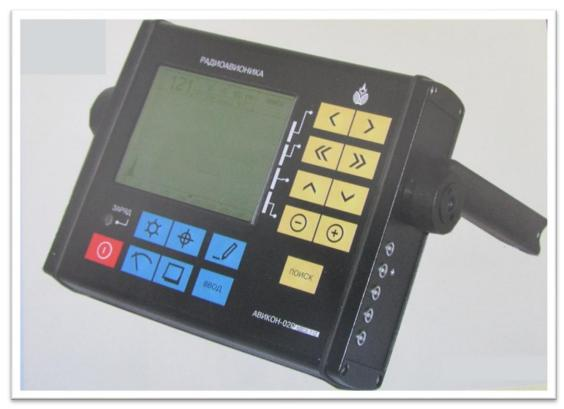
Рисунок 48. Ультразвуковой портативный дефектоскоп Авикон-02Р
