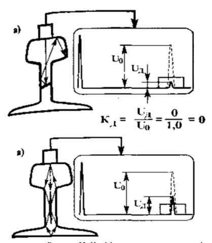
Рисунок 32. Коэффициент выявляемости дефектов
