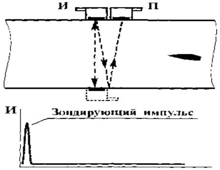
Рисунок 19. Зеркально теневой метод ультразвукового контроля донным сигналом
