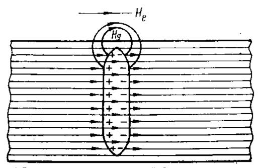
Рисунок 4. Схема поляризации стенок внутренней области в намагниченном стержне
