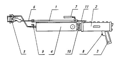
1-штанга; 2- электронный блок; 3-рукоятка; 4- бак для жидкости; 5-блок преобразователя; 6-кронштейн; 7-дополнительная рукоятка; кнопка отключения; 9- кран подачи жидкости; 10 накидная гайка; 11-кабель Рисунок 50. Конструкция дефектоскопа
