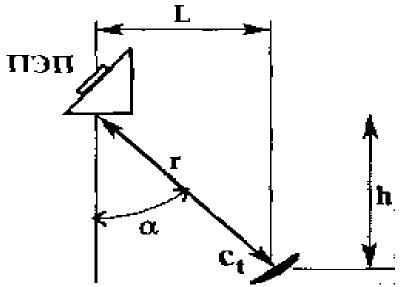
r — расстояние от точки ввода ультразвуковых колебаний до Рисунок 25. Ввод ультразвуковых колебаний спомощю наклонных ПЭП
