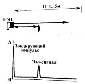
Рисунок 23 Расстояние до противоположной поверхности значительное. Донный сигнал отсутствует
