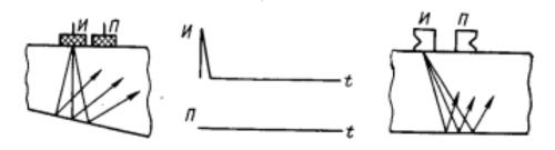
Рисунок 21. При непараллельных поверхностях донный сигнал отсутствует.
