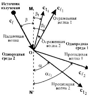
Рисунок 15. Отражение и преломление ультразвуковых волн.
