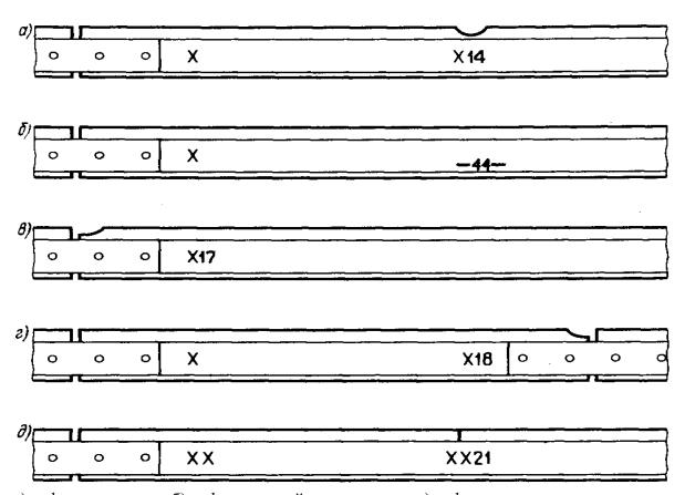
а) дефект вне стыка; б) дефект по всей длине рельса; в) дефект на левом конце рельса; г) дефект на правом конце рельса; д) остродефектный рельс при расположении дефекта вне стыка.
