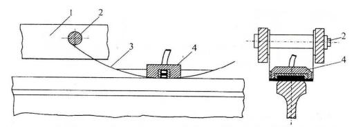
Рисунок 9. Лыжа с искательной катушки.
