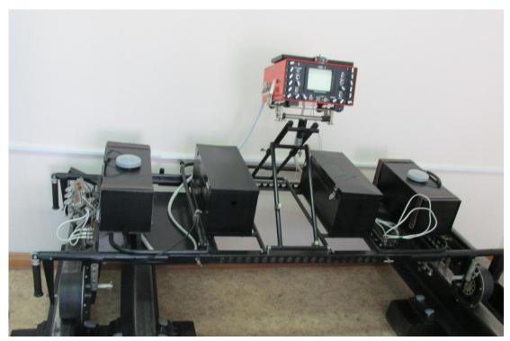
Рисунок 56. Ультразвуковой дефектоскоп РДМ-2
