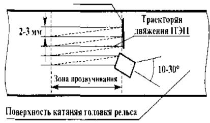
Рисунок 28. Схема сканирования при уточнении координат обнаруженного дефекта с помощью ручного ПЭП
