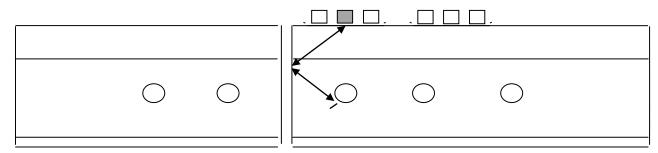
Рисунок 61 - Вариант контроля ближнего к стыку болтового отверстия лучом, отраженным от торцевой стенки рельса
