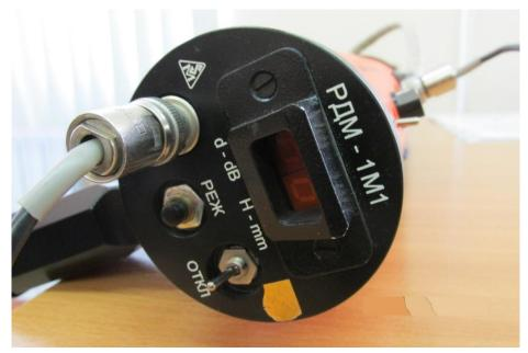
Рисунок 51. Вид передней панели электронного блока дефектоскопа
