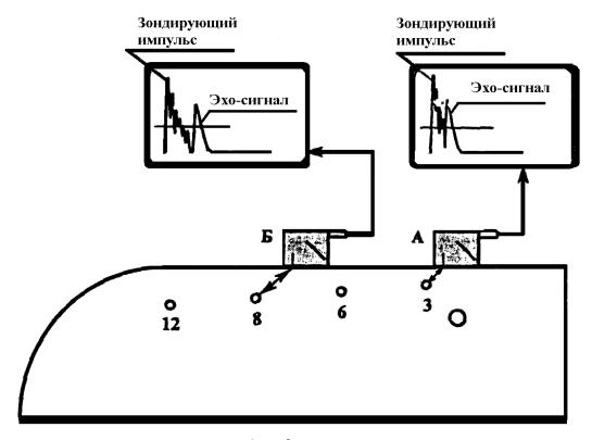
A – это сигнал от отверстия на глубине 3 мм сливается с зондирующим импульсом, M>3 мм; B – эхо – сигнал от отверстия на глубине 8мм наблюдается отдельно от зондирующего импульса, M<8 мм.
