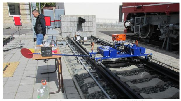
Рисунок 53. Ультразвуковой дефектоскоп АВИКОН-01
