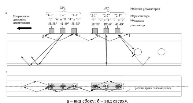
Рисунок 58. Схема прозвучивания рельсов при сплошном контроле
