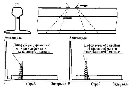
Рисунок 35. Процесс формирования сигналов наклонными ПЭП
