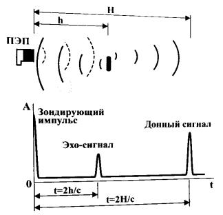
Рисунок 20. Формирование эхо- и донного сигнала
