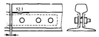
Рисунок 36. Основные элементы болтового стыка рельса и характерные дефекты в зоне стык
