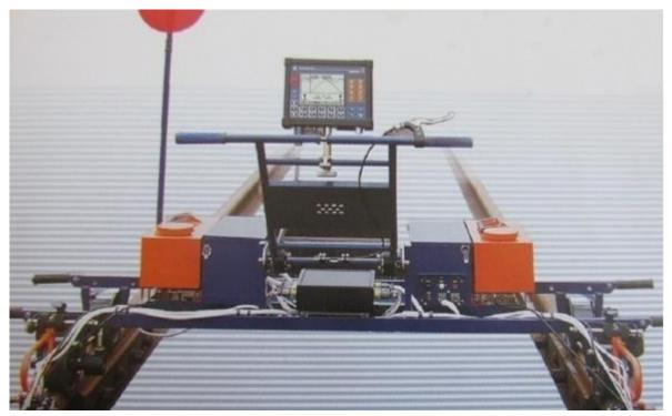
Рисунок 54. Ультразвуковой дефектоскоп АВИКОН-11
