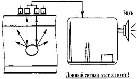
Рисунок 38. Ложное срабатывание дефектоскопа, реализующего схему «ультразвуковой калибр», при озвучивании бездефектного болтового отверстия с овальным профилем
