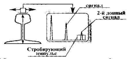
Рисунок 34. Выделение второго донного сигнала с помощью стробируещего импульса.
