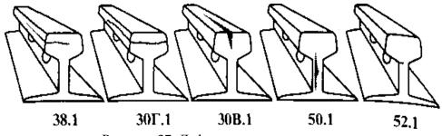
Рисунок 37. Дефекты в головке рельса
