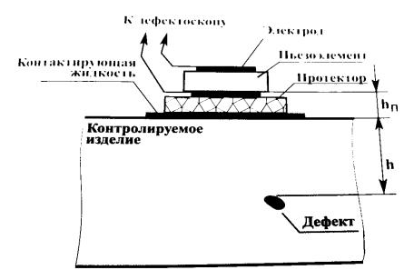
Рисунок 16. Ввод ультразвуковых колебаний с помощью прямого преобразователя
