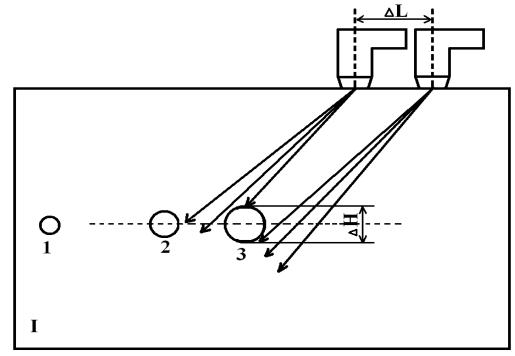
Рисунок 30. Определение условной высоты дефекта
