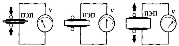
Рисунок 12. Иллюстрация прямого пьезоэффекта
