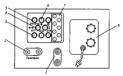
1 — разъемы для подключения преобразователей к 1 и 2 каналам дефектоскопа; 2 — розетка для подключения телефона; 3 — птенциометры (Р17, Р18, Р19) для настройки режима электронно-лучевой трубки; 4 — 0регуляторы смещения ЭЛТ по вертикали и горизонтали; 5 — регулятор «отсечка»; 6 - -регуляторы яркости и фокусировки луча ЭЛТ; 7 — разъемы для подключения синхронизации; 8 блок питания от сети 220 в
