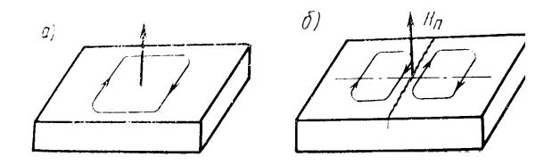
Рисунок 6. Распределение магнитных силовых линий вокруг рельса при циркулярном намагничивании
