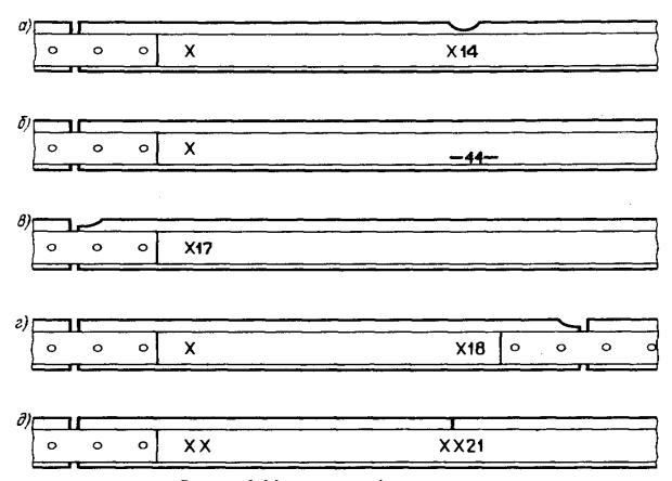
Рисунок 3. Маркировка дефектных рельс
