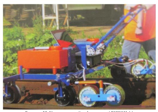
Рисунок 55. Ультразвуковой дефектоскоп АВИКОН-14
