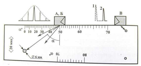
Рисунок 42. Стандартный образец СО-2
