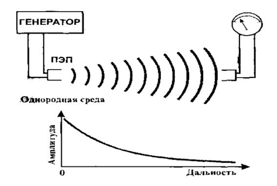
Рисунок13. Зависимость затухания ультрозвуковых колебаний от расстояния
