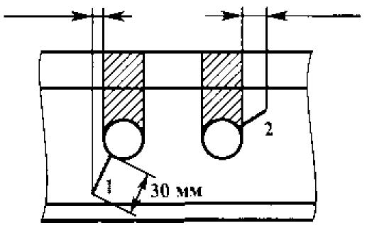
Рисунок 39. Дефект небудет обнаружен т.к. гарантируется обнаружение только тех дефектов 53.1, у которых проекция на поверхность катания выходит за проекцию болтового отверствия более, чем на10 мм
