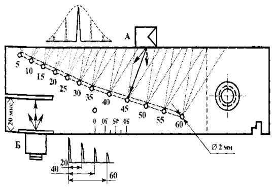
Рисунок 41. Стандартный образец СО-1
