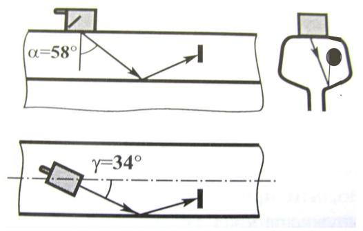
Рисунок 26. Углы ввода (α) и разворота (γ) ультразвуковых колебаний в головку рельса
