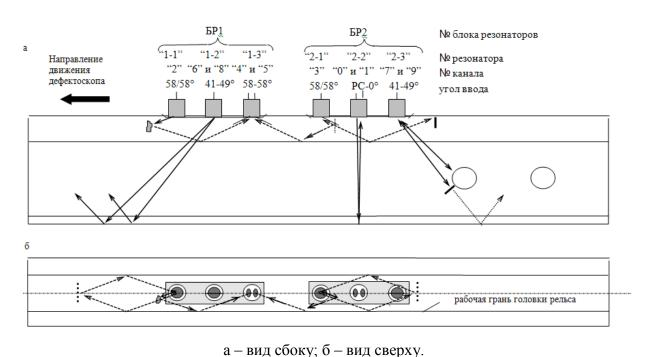
Рисунок 57. Схема прозвучивания рельсов при сплошном контроле
