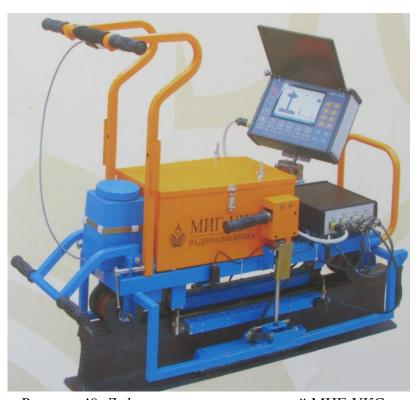
Рисунок 49. Дефектоскоп ультразвуковой МИГ-УКС
