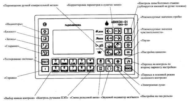
Рисунок 59. Вид панели управления дефектоскопа
