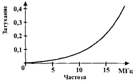
Рисунок 14. Зависимость коэффициента затухания ультразвуковых колебаний (при нормальном падении волн)
