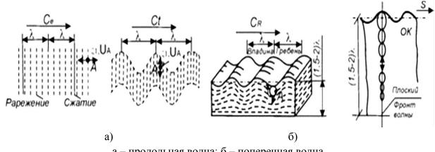
а – продольная волна; б – поперечная волна Рисунок 10. Типы ультразвуковых волн
