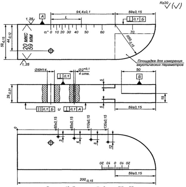
Рисунок 43. Стандартный образец СО – 3Р
