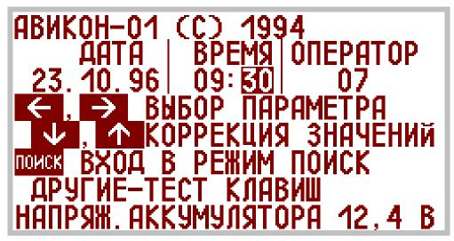
Рисунок 60. Информация на экране ЖКД в режиме работы дефектоскопа "ВВОД СЛУЖЕБНОЙ ИНФОРМАЦИИ"
