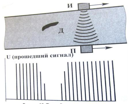
Рисунок18. Теневой метод ультразвукового контроля
